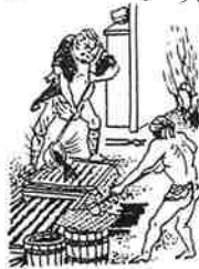
江戸時代の銅の製錬法 上：荒銅を間吹きして精銅にする。 下：精銅を型に流して埴銅にする。 （日本歴史図録より）
