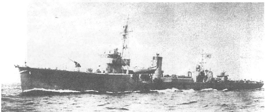
佐伯湾を拠点に活躍した敷設艇「怒和島」の勇姿 (全長 74.70m・速力 20K T・乗員 70 余名)
